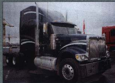
19. International-9900. Единственный пока такой тягач в России. Двигатель Cummins мощностью 640 л.с. В кабине можно жить семьей.
