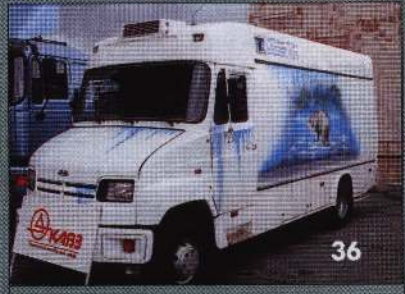
36. Курганский автобусный завод после разработки серии собственных автобусов средней вместимости на шасси горьковского грузовика переключился на постройку автобусных кузовов и фургонов на шасси «Бычка». Изотермический фургон с холодильной установкой.
