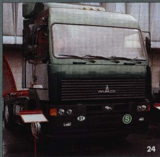
26. Трехосный магистральный тягач «МАЗ – МАН» для транспортировки тяжелых грузов. Полная масса автомобиля до 65 000 кг. Мощность двигателя 460 л.с. Качество – почти европейское.
