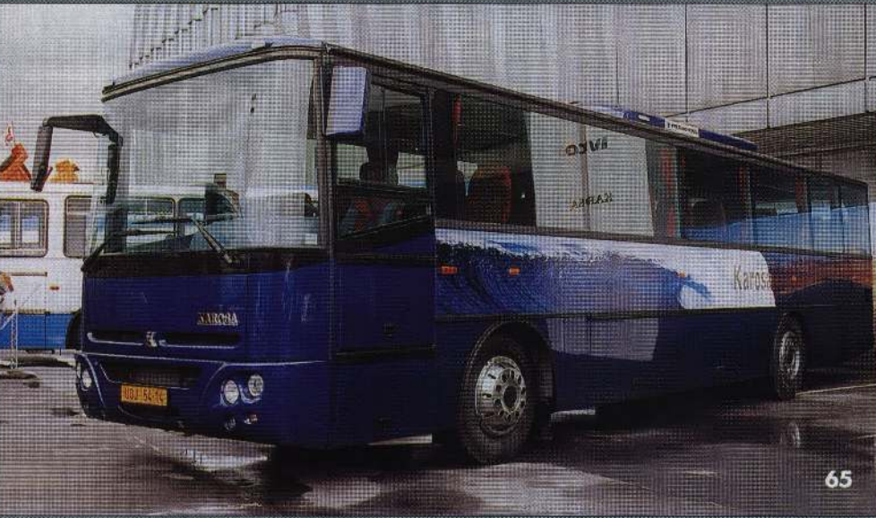
65. Туристический автобус Karsa LC936XE на 49 мест. Двигатель Renault мощностью 217 кВт при 2100 об./мин.
