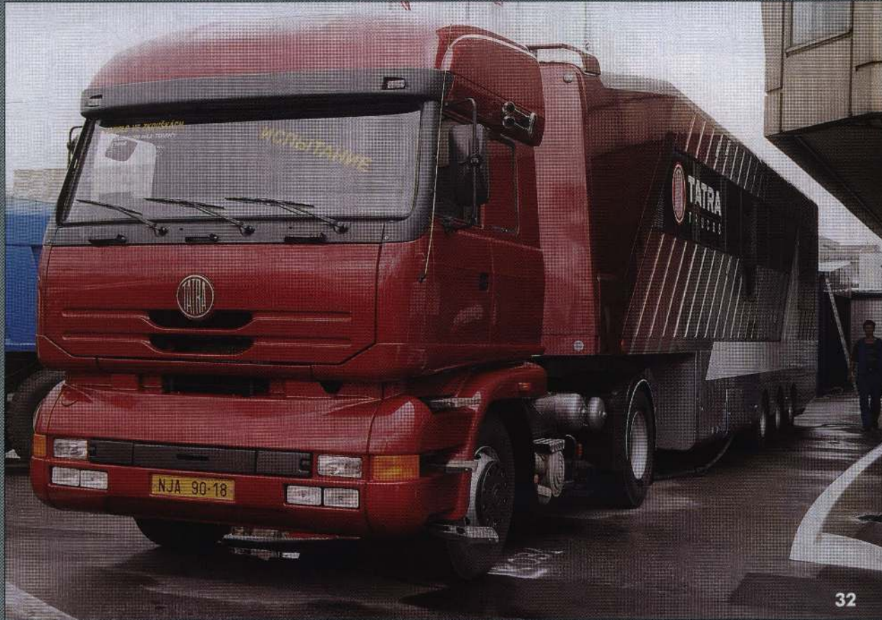
27. Седельный тягач Tatra с новой пластиковой обвеской нижнего и верхнего аэродинамического пояса имеет выдвижные ступени и буксирует передвижной офис фирмы на все автомобильные выставки.
