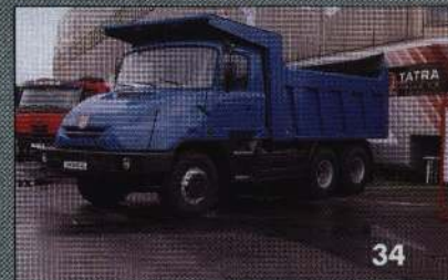
34, 34а. Карьерный самосвал Tatra - Kamal в капотной компоновке получил новый кузов. Рабочее место водителя удобно и комфортно.
