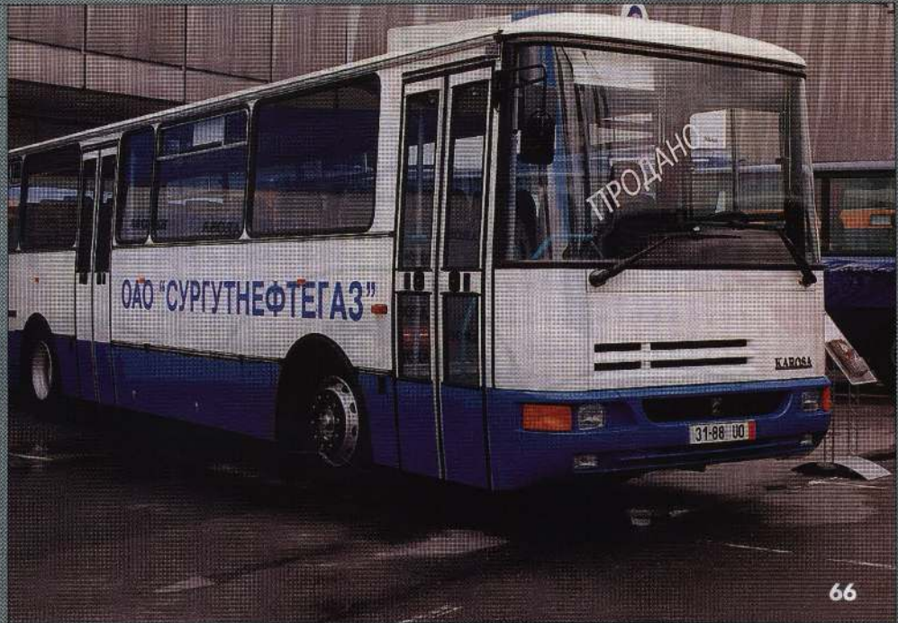
66. Междугородный автобус из Чехии Karosa C934E. Количество мест для сидения 46, двигатель Renault мощностью 188 кВт.
