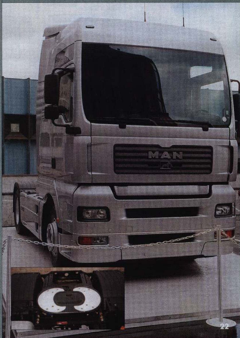
22. Новейший магистральный тягач MAN TG-A с кабиной XXL напичкан электроникой. Седло имеет специальные пластиковые вставки, что позволяет обходиться без смазки.
