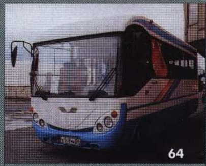
64. «ГолАЗ-4244». Число мест для сидения 32. Шасси Daewoo AVIA AD90 EL. Двигатель AVIA D 421 мощностью 115 л.с.
